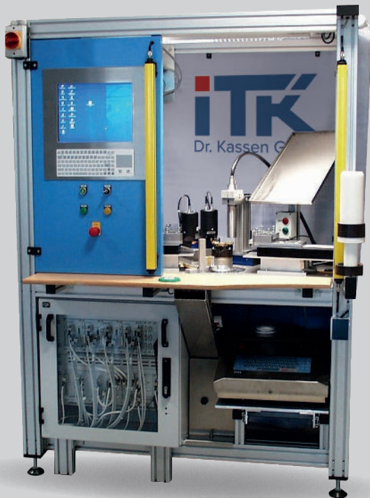
OBEN: Rundmagnetisieranlage RECHTS: Beschreibsystem als Teil der Magnetisieranlage
